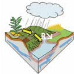
Schéma des écoulements pris en compte - précipitations, ruissèlement, eaux superficielles et souterraines - associés aux pratiques agricoles de culture du maïs.
