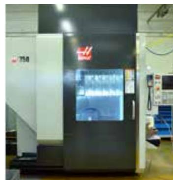
Le centre d'usinage numérique 5 axes.
